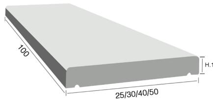
**NOTA** Nos couvertines plates sont volontairement très légèrement galbées pour garantir un bon écoulement des eaux de pluie.
